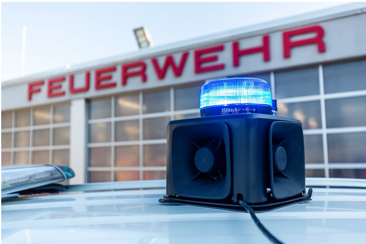
Mobiles Warn- und Kommunikationssystem (MOWACOM) auf einem Fahrzeugdach.
